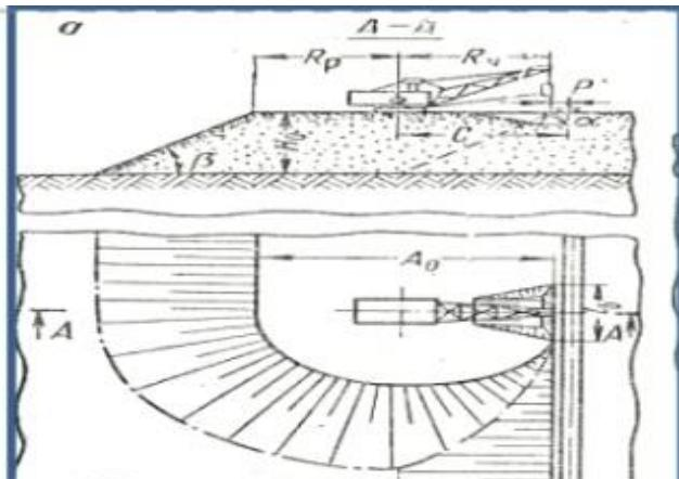
**14.3 – rasm. Avtomobil transporti qo'llanilganda draglayn yordamida ag'darma hosil qilish konstruksiyasi.**
