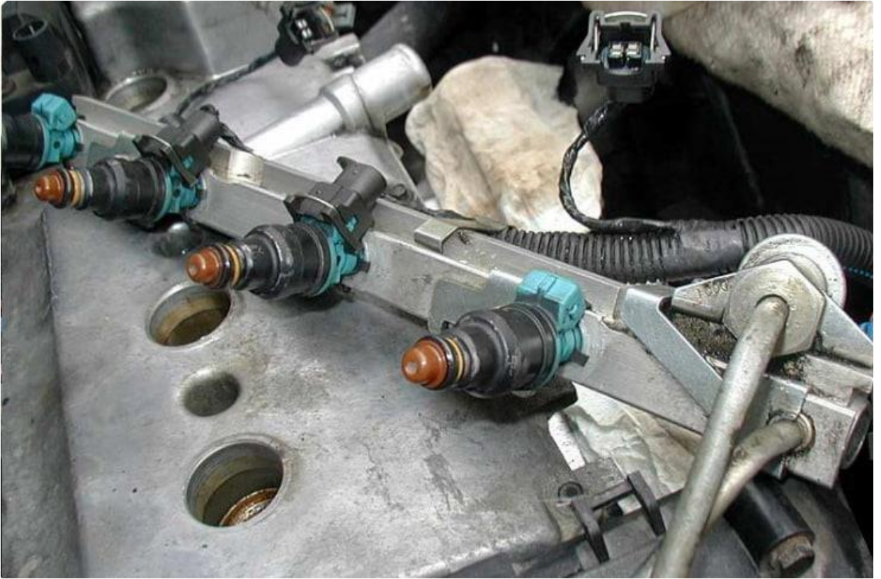
2-rasm: Yonilg'ini po'rshinlarga taqsimlash qurulmasi:
